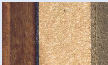
8. Připojení odolné vůči větru a vodě, okenní špaleta/okenní rám
